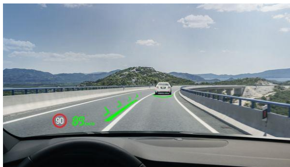
EB aware sammelt Daten zur Fahrzeugumgebung und bündelt sie zu sinnvollen Informationen auf dem Head-Up-Display
