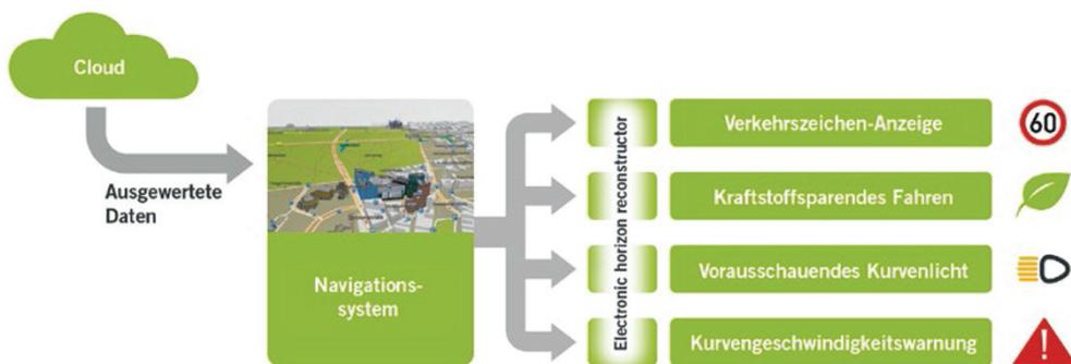
**BILD 2** Analyierte Daten werden in das Kartenmaterial des Navigationssystems integriert und über einen Sender-Empfänger-Mechanismus (Provider/Rekonstruktor) für Fahrerassistenzfunktionen nutzbar gemacht
